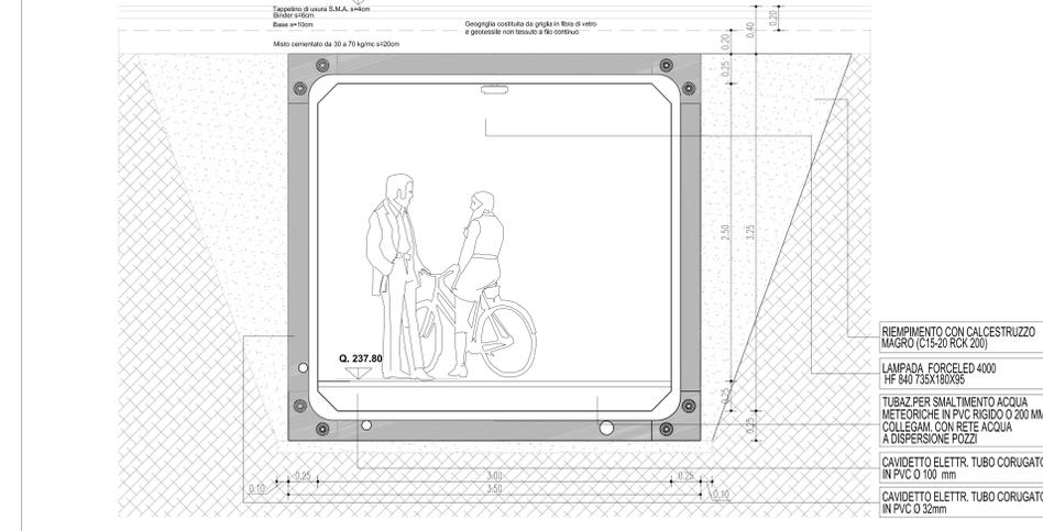
DETTAGLIO SOTTOPASSO - MONOLITE PREFABBRICATO (ditta COPREM) 1:20
