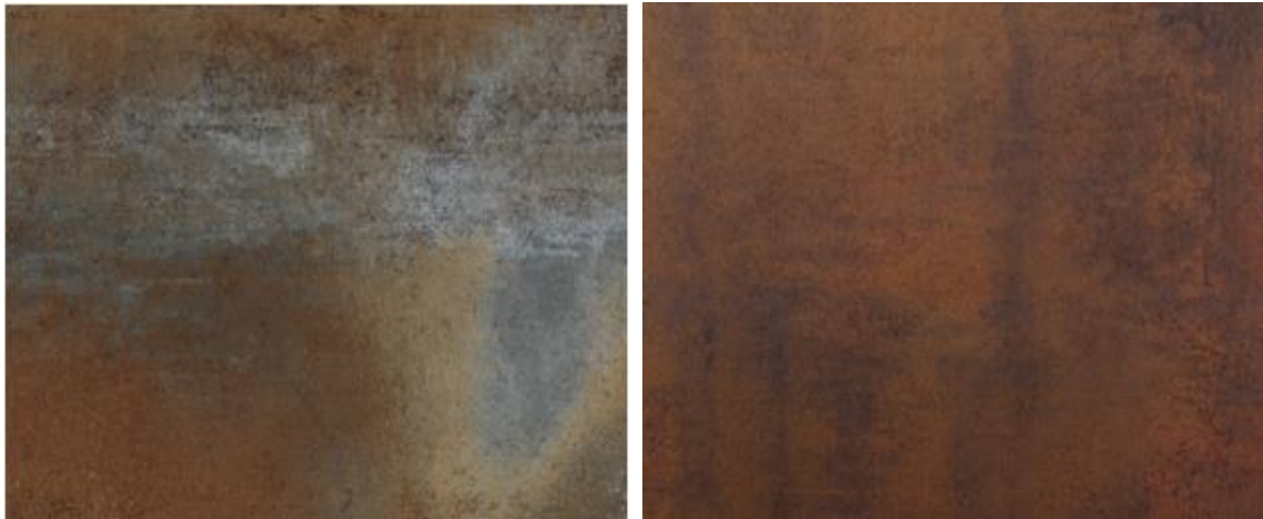
Una lamiera di Cor-ten prima e dopo il completamento del processo di ossidazione.
