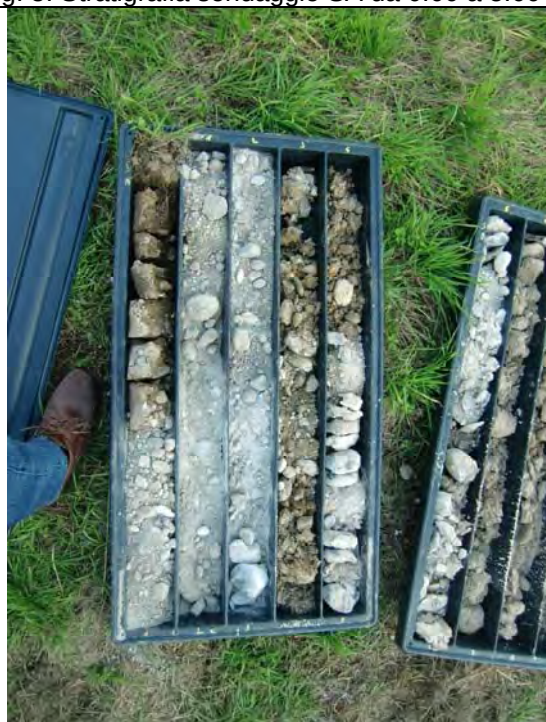
Fig. 7: Stratigrafia sondaggio SB da 0.00 a 5.00 m
