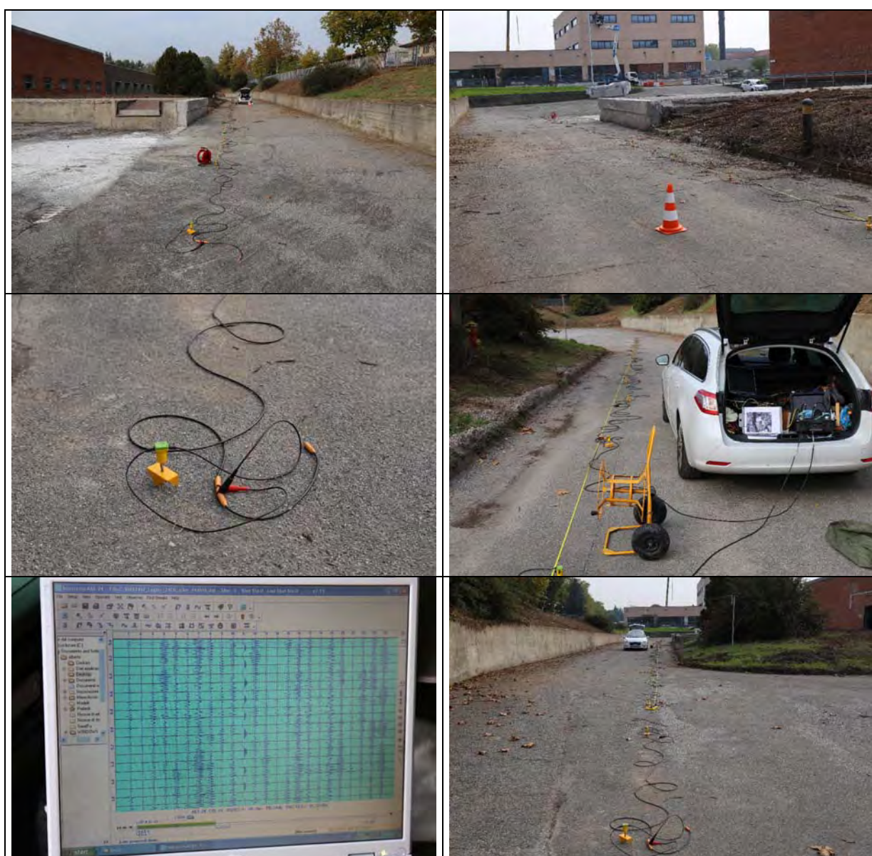
Figura 10 - Profilo 2. Misura in sito delle onde di taglio orizzontali V_{s30} m.
