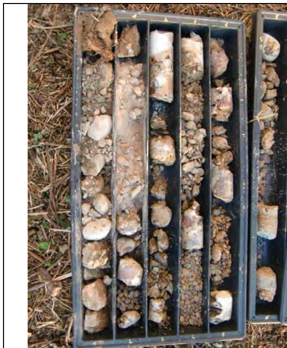
Fig. 5: Stratigrafia sondaggio SA da 0.00 a 5.00 m
