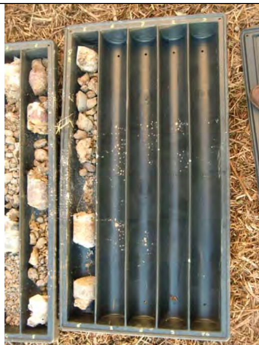
Fig. 6: Stratigrafia sondaggio SA da 5.00 a 6.00 m
