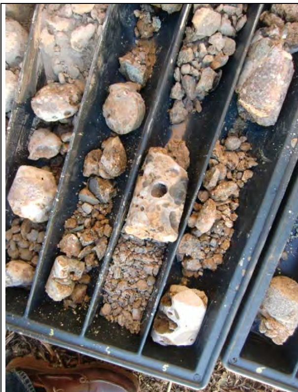
Fig. 9: Particolare di conglomerato rinvenuto a profondità di ca 3,80 m da p.c. nel sondaggio SA
