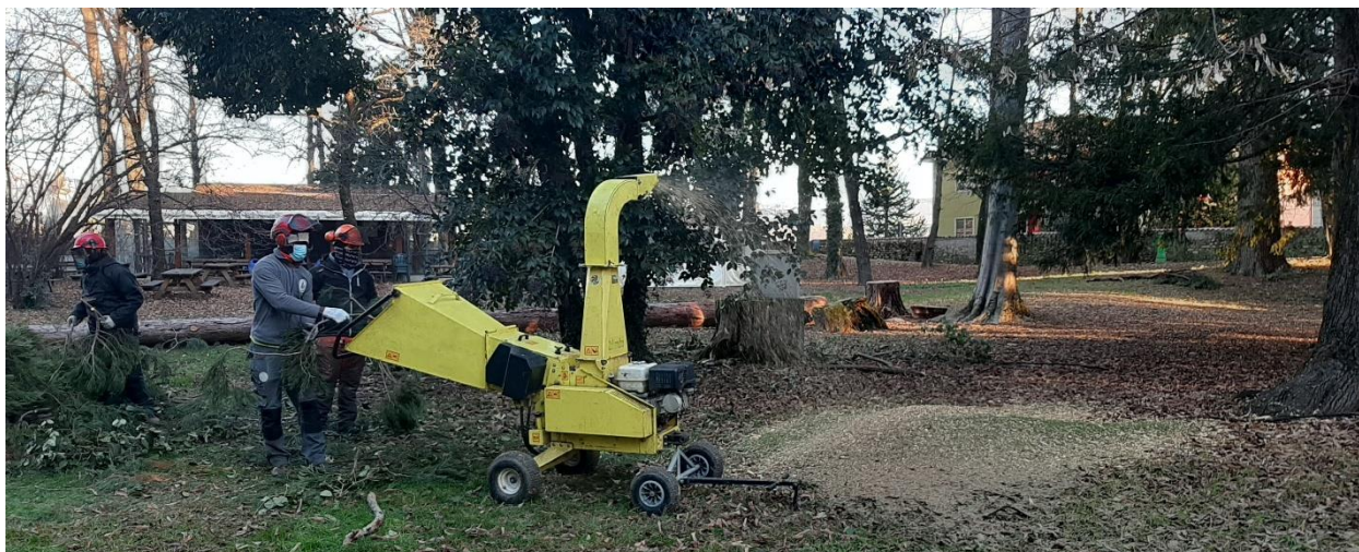
Esempio di cippatrice leggera a basso impatto sul suolo
